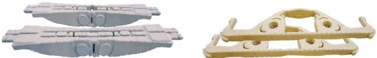
Стержни балки надрессорной и рамы боковой Китайской Железной Дороги, длина около 2500 / 2300 мм
